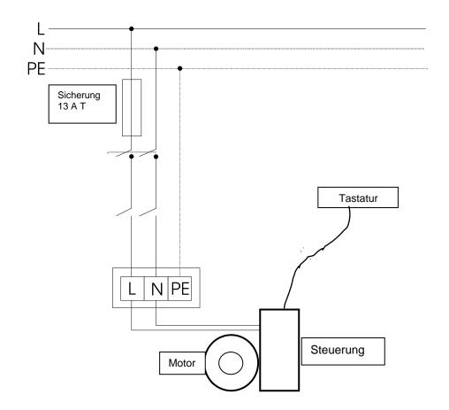
Für den Anschluss des Systems ist eine separate Sicherung (13A Träge) vorzusehen.
